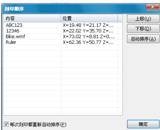
刻印顺序调整窗口中，列表里按当前刻印顺序列出了视图中所有标记的内容以及位置，选择其中一个，然后点击“上移”或“下移”就可改变这个标记的刻印顺序。更简单的办法，直接点击“自动排序”按钮，刻印控制软件将自动按从上到下，从左到右的顺序对所有标记进行排序，这也是最常用的排序方法。
