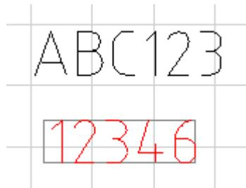
流水号标记的内容由“12345”改变为“12346”了，这就是流水号编码的作用，每一个使用了流水号编码的标记，都将在刻印完后自动累加一个数，如果您没有改变流水号编码的参数，那么将是累加“1”。
