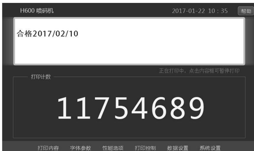
如果打印控制方式为“光电打印”，则光电开关检测到产品时即打印一条信息，并计数一次。
